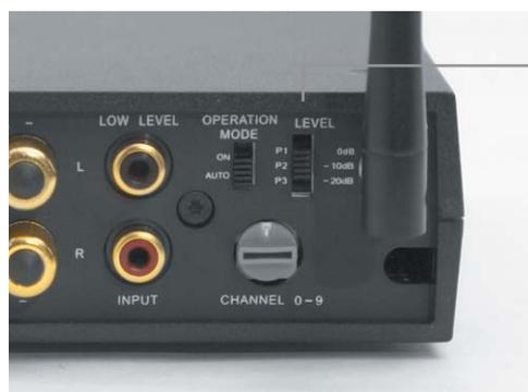
An den CD 3500 wireless selbst befindet sich ein mit Output Level gekennzeichnete Schalter (Abb. 4) mit der entsprechenden Gegenfunktion. Bitte achten Sie darauf, dass die am Transceiver gewählte Schalterstellung auch an den Output Level Schaltern der Lautsprecher gewählt wird. So muss z. B. bei der Schalterstellung P 1 am Transceiver auch die Schalterstellung P 1 an den Lautsprechern gewählt werden.
